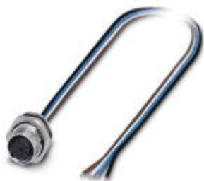
Sensor-/Aktor-Einbaubuchse, 4-polig, M12-SPEEDCON, Hinterwand-/Schraubmontage mit M16-Gewinde, mit 0,5 m TPE-Litze, 4 x 0,34 mm<sup>2</sup>
