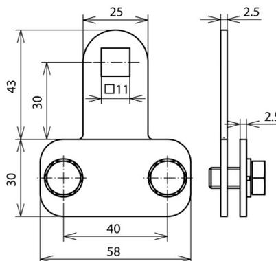
Klemmstück mit Federring zum Anschluss von Flachmaterial an Konstruktionsteile. Blitzstromtragfähigkeit 200 kA (10/350 µs)
