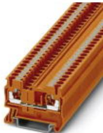
Durchgangsreihenklemme, Anschlussart: Push-in, Querschnitt: 0,08 mm<sup>2</sup> - 4 mm<sup>2</sup>, AWG 28 - 12, Breite: 5,2 mm, Farbe: orange, Montageart: NS 35/7,5, NS 35/15
