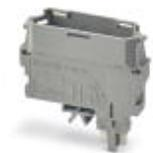
Bauelementestecker, zum Einbau von selbst wählbaren Bauelementen bis zu einem Durchmesser von 10 mm und einer Verlustleistung bis 1 W, Nennstrom: 10 A, Länge: 41,2 mm, Breite: 12,3 mm, Höhe: 37,5 mm, Polzahl: 1, Farbe: grau
