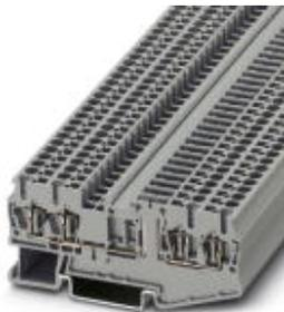
Trennklemme, Nennspannung: 400 V, Nennstrom: 20 A, Anschlussart: Zugfederanschluss, Querschnitt: 0,08 mm<sup>2</sup> - 4 mm<sup>2</sup>, AWG: 28 - 12, Länge: 84 mm, Breite: 5,2 mm, Farbe: grau, Montage: NS 35/7,5, NS 35/15, Nennspannung: 400 V
