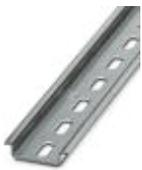
Tragschiene gelocht, Standardprofil, Breite: 35 mm, Höhe: 7,5 mm, nach EN 60715, Material: Stahl, verzinkt, Länge: 2000 mm, Farbe: silberfarben
