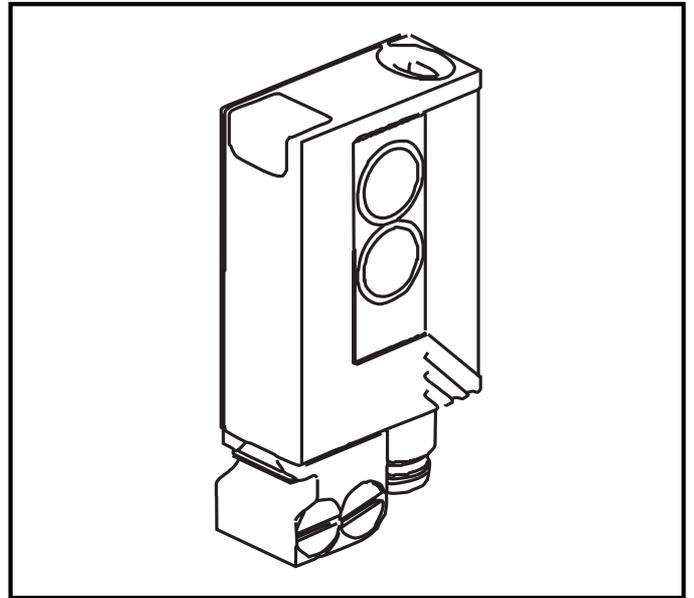
Schrauben Sie die Halterung mit den beigelegten Schrauben fest und schieben Sie das Gerät in die Führung des Halters bis die Haltefeder einrastet.
