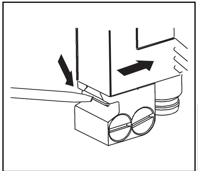
Zum Lösen des Gerätes drücken Sie die Haltefeder mit Hilfe eines Schraubendrehers nach unten und ziehen das Gerät von der Halterung.
