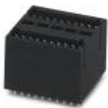
Leiterplattengrundleiste, Nennstrom: 4 A, Bemessungsspannung (III/2): 160 V, Polzahl: 2, Rastermaß: 2,5 mm, Farbe: schwarz, Kontaktfläche: Zinn, Montage: THR-Löten, Standardbauelement aus hochtemperaturfähigem Kunststoff; für Reflowprozesse geeignet. Anwenderinformationen und Designempfehlungen zur Through Hole Reflow Technologie finden Sie unter "Downloads"
