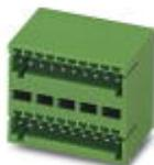
Leiterplattengrundleiste, Nennstrom: 4 A, Bemessungsspannung (III/2): 160 V, Polzahl: 2, Rastermaß: 2,5 mm, Farbe: grün, Kontaktoberfläche: Zinn, Montage: Wellenlöten
