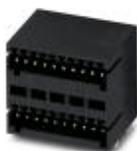
Leiterplattengrundleiste, Nennstrom: 4 A, Bemessungsspannung (III/2): 160 V, Polzahl: 2, Rastermaß: 2,5 mm, Farbe: schwarz, Kontaktoberfläche: Zinn, Montage: THR-Löten, Standardbauelement aus hochtemperaturfähigem Kunststoff; für Reflowprozesse geeignet. Anwenderinformationen und Designempfehlungen zur Through Hole Reflow Technologie finden Sie unter "Downloads"
