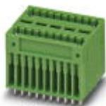
Leiterplattengrundleiste, Nennstrom: 4 A, Bemessungsspannung (III/2): 160 V, Polzahl: 2, Rastermaß: 2,5 mm, Farbe: grün, Kontaktoberfläche: Zinn, Montage: Wellenlöten
