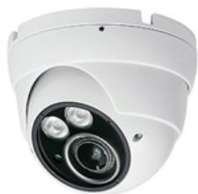
Night & Day-Kugelkamera IP66 mit 2,8 – 12 mm Vario-Objektiv 1/2,9" 2,2 MP CMOS Farbsensor, Auflösung: 1920 x 1080 Pixel, Kamerawinkel: 98° bis 32° horizontal/78° bis 25° vertikal, Stromversorgung: 12 V DC / 460 mA, 2 Hochleistungs-IR-LEDs mit 25 m Beleuchtungsweite, OSD-Menü, 0 Lux bei eingeschalteter LED, Farbe: Weiß, Abmessungen: Ø 119 x 100 mm, 12 V DC-Buchse und BNC-Adapter im Lieferumfang enthalten.
