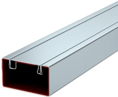
Stahlblechkanal mit intumeszierender Innenbeschichtung. Verhindert im Brandfall aktiv die Brandweiterleitung im Kanal und schützt Flucht- und Rettungswege vor den Auswirkungen eines Kabelbrands. Ober- und Unterteil werden über die selbstkontaktierenden, patentierten Rastklammern sicher miteinander verbunden. Hiermit wird auch der Potentialausgleich hergestellt. Feuerwiderstandsklassen I30 bis I120 gemäß DIN 4102 Teil 11.
