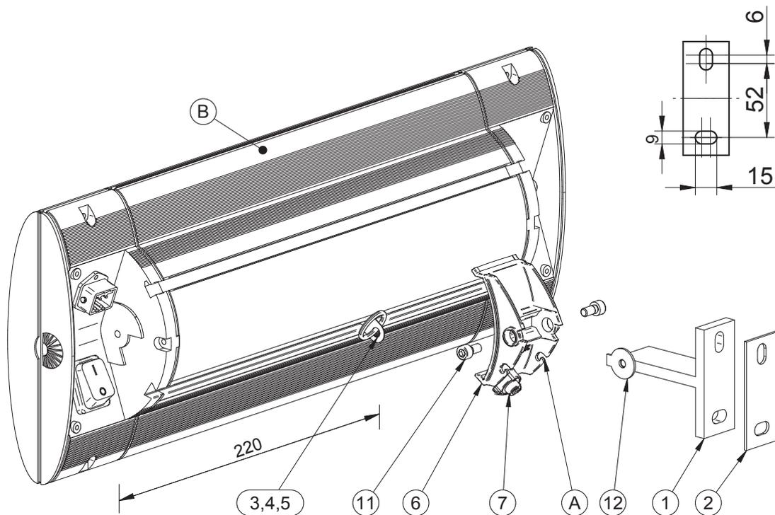
MONTAGE FÜR STRAHLER SOLAMAGIC® S3 MIT T-HALTER
