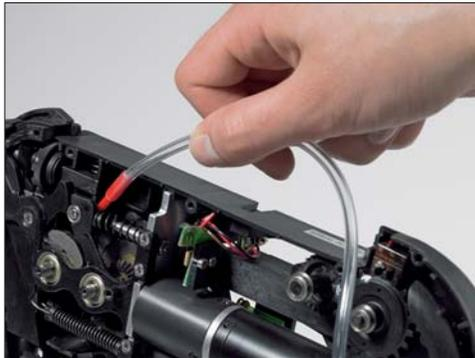
Mit Hilfe des Sprühschlauchs lassen sich ansonsten unzugängliche Stellen optimal reinigen.
