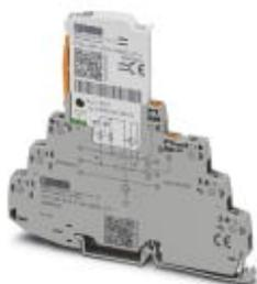
Überspannungsschutz, bestehend aus Schutzstecker und Basiselement, mit integrierter Statusanzeige und Trennmesser für zwei Signaladern mit gemeinsamem Bezugspotenzial, z. B. Digital IN/OUT. Indirekte Erdung über Gasableiter.
