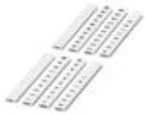
Zackband flach, Streifen, weiß, beschriftet, quer bedruckt: fortlaufende Zahlen 1-10, 11-20 usw. bis 91-100, Montageart: verrasten in flacher Schildchennut, für Klemmenbreite: 6,2 mm, Schriftfeldgröße: 5,15 x 6,15 mm
