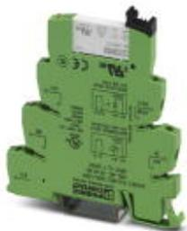
PLC-INTERFACE für Eingabefunktionen, bestehend aus Grundklemme PLC-BSC.../SEN mit Schraubanschluss und steckbarem Miniaturrelais mit Mehrlagen-Goldkontakt, zur Montage auf Tragschiene NS 35/7,5, 1 Schließer, Eingangsspannung 24 V DC
