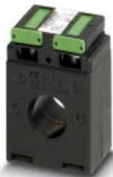
Rohrstabstromwandler, Primärstrom 400 A AC; Sekundärstrom 5 A AC; Genauigkeitsklasse 1; Bemessungsleistung 5 VA
