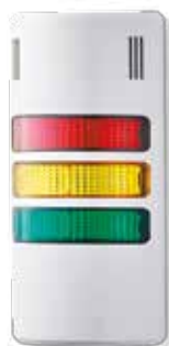
Artikel-Nr.: HD90-Q37 Farben: rot-gelb-grün Funktion: LED Dauerlicht, Summer Dauer- oder Pulston Gehäusefarbe: grau Nennspannung: 24 V AC/DC
