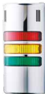
Artikel-Nr.: HD90-Q97 Farben: rot-gelb-grün Funktion: LED Dauerlicht, Summer Dauer- oder Pulston Gehäusefarbe: chrom Nennspannung: 230-240 V AC
