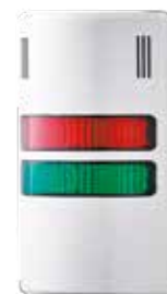
Artikel-Nr.: HD90-Q82 Farben: rot-grün Funktion: LED Dauerlicht, Summer Dauer- oder Pulston Gehäusefarbe: grau Nennspannung: 230-240 V AC
