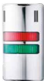
Artikel-Nr.: HD90-Q92 Farben: rot-grün Funktion: LED Dauerlicht, Summer Dauer- oder Pulston Gehäusefarbe: chrom Nennspannung: 230-240 V AC
