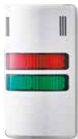
Artikel-Nr.: HD90-Q32 Farben: rot-grün Funktion: LED Dauerlicht, Summer Dauer- oder Pulston Gehäusefarbe: grau Nennspannung: 24 V AC/DC
