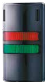
Artikel-Nr.: HD90-Q992 Farben: rot-grün Funktion: LED Dauerlicht, Summer Dauer- oder Pulston Gehäusefarbe: schwarz Nennspannung: 230-240 V AC
