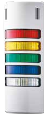
Artikel-Nr.: HD90-Q1036 Farben: rot-gelb-grün-blau-klar Funktion: LED Dauerlicht, Summer Dauer- oder Pulston Gehäusefarbe: grau Nennspannung: 24 V AC/DC
