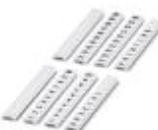
Zackband flach, Streifen, weiß, unbeschriftet, beschriftbar mit: CMS-P1-PLOTTER, PLOTMARK, Montageart: verrasten in flacher Schildchennut, für Klemmenbreite: 3,5 mm, Schriftfeldgröße: 3,5 x 5,2 mm
