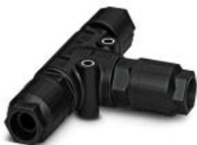
T-Verteiler, QUICKON-Anschluss, Polzahl: 4+PE, 0,5 mm<sup>2</sup> ... 1,5 mm<sup>2</sup>, 690 V, 17,5 A, schwarz, mit drei QUICKON-Muttern, Kabeldurchmesser: 9 mm ... 14 mm
