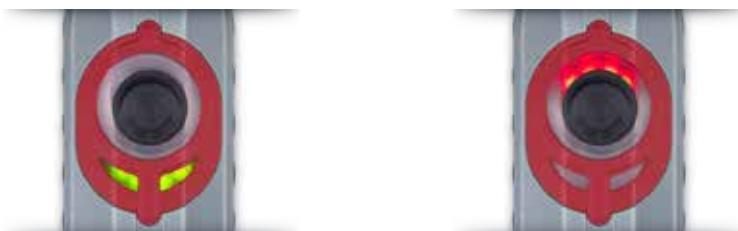
Nach Inbetriebnahme des elektrischen Verbrauchers dient der **PRCD-S+** als **Fehlerstromschutzschalter** und schützt den Anwender so gegen gefährliche Ströme, welche durch defekte elektrische Betriebsmittel verursacht werden können. Darüber hinaus verfügt der **PRCD-S+** über eine **Unterspannungsauslösung**, welche ein selbständiges Wiedereinschalten des Verbrauchers nach einem Stromausfall verhindert.
