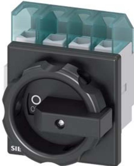
SENTRON, Lasttrennschalter 3LD, Hauptschalter, 4-polig, I<sub>n</sub>: 25 A, Betriebsleistung / bei AC-23 A bei 400V: 9,5 kW, Frontbefestigt, Drehantrieb, schwarz, 4-Loch Befestigung der Handhabe
