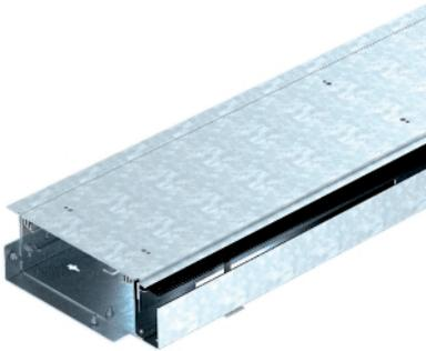
Montagefertige Kanaleinheit zur Leitungsführung und zum Geräteeinbau, bestehend aus einem Kanalunterteil mit zwei Deckeln und höhenverstellbarer Bürstenleiste und einem Bodenbelaganlegeprofil. Im Lieferumfang enthalten sind zwei Deckelstoßdichtungen und ein Verbinder. Zur Höheneinstellung werden sechs Nivelliereinheiten benötigt.
