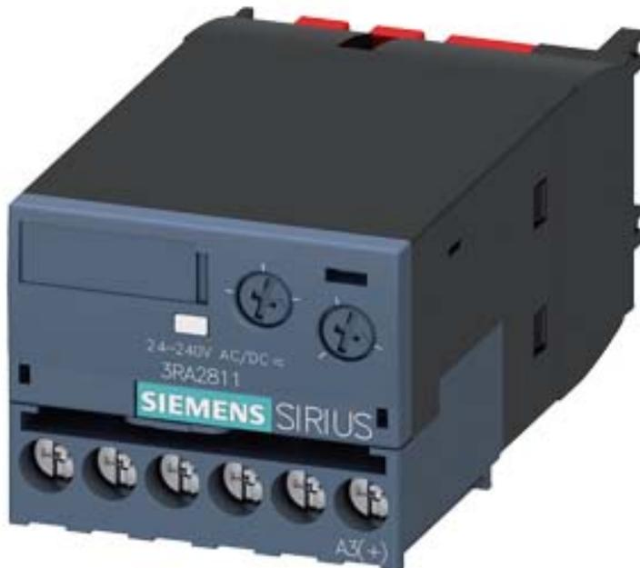
Elektronisches Zeitrelais ansprechverzögert mit Halbleiterausgang AC/DC 24-240 V Zeitbereich 0,05...100 s frontseitig aufschraubbar für Schütze 3RT2 S00/S0 Schraubanschluss Varistor zur Bedämpfung der Schützpulen integriert
