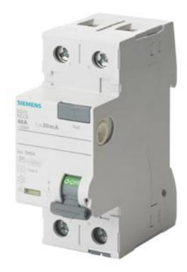
FI-SCHUTZSCHALTER TYP A 40A 1+N-POL 30MA 230V 2TE KURZZEITVERZOEGERT G THERMISCHER UEBERLASTSCHUTZ BIS NENNSTROM MOEGLICH
