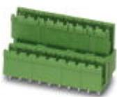
Grundgehäuse, Nennstrom: 10 A, Bemessungsspannung (III/2): 320 V, Polzahl: 5, Rastermaß: 5 mm, Farbe: grün, Kontaktoberfläche: Zinn, Montage: Wellenlöten, Anreihbar! Befestigungsflansch: Art.-Nr. 1836477, 1836480. Bei Kombination mit MVSTB- oder FKCV-Steckerteilen ist jeweils ein MVSTBW- (bzw. FKCVW-) und ein MVSTBR-Stecker (bzw. FKCVR-) zu verwenden. Kombination mit TMSTBP-Steckerteilen ist nicht möglich!
