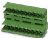
Grundgehäuse, Nennstrom: 10 A, Bemessungsspannung (III/2): 320 V, Polzahl: 5, Rastermaß: 5 mm, Farbe: grün, Kontaktfläche: Zinn, Montage: Wellenlöten, Anreihbar! Befestigungsflansch: Art.-Nr. 1736771, 1736768. Bei Kombination mit MVSTB- oder FKCV-Steckerteilen ist jeweils ein MVSTBW- (bzw. FKCVW-) und ein MVSTBR-Stecker (bzw. FKCVR-) zu verwenden. Kombination mit TMSTBP-Steckerteilen ist nicht möglich !
