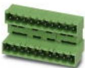
Grundgehäuse, Nennstrom: 10 A, Bemessungsspannung (III/2): 320 V, Polzahl: 5, Rastermaß: 5 mm, Farbe: grün, Kontaktoberfläche: Zinn, Montage: Wellenlöten, Der Artikel ist zu unterschiedlichen Polzahlen anreihbar! Bei Kombination mit MVSTB- oder FKCV-Steckerteilen ist jeweils ein MVSTBW- (bzw. FKCVW-) und ein MVSTBR-Stecker (bzw. FKCVR-) zu verwenden. Kombination mit TMSTBP-Steckerteilen ist nicht möglich!
