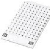
Kennzeichnungskarte, Karte, weiß, beschriftet, längs: fortlaufende Zahlen 1-10, 11-20 usw. bis 91-(99)100, Montageart: Kleben, für Klemmenbreite: 5 mm, Schriftfeldgröße: 5 x 3,8 mm
