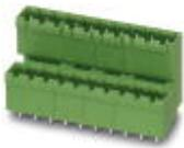
Grundgehäuse, Nennstrom: 10 A, Bemessungsspannung (III/2): 320 V, Polzahl: 5, Rastermaß: 5 mm, Farbe: grün, Kontaktoberfläche: Zinn, Montage: Wellenlöten, Der Artikel ist zu unterschiedlichen Polzahlen anreihbar! Bei Kombination mit MVSTB- oder FKCV-Steckerteilen ist jeweils ein MVSTBW- (bzw. FKCVW-) und ein MVSTBR-Stecker (bzw. FKCVR-) zu verwenden. Kombination mit TMSTBP-Steckerteilen ist nicht möglich!
