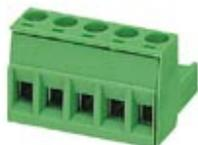
Steckerteil, Nennstrom: 12 A, Bemessungsspannung (III/2): 320 V, Polzahl: 5, Rastermaß: 5 mm, Anschlussart: Schraubanschluss mit Zughülse, Farbe: grün, Kontaktoberfläche: Zinn
