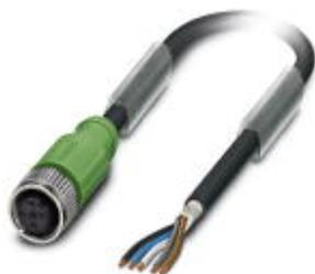
Sensor-/Aktor-Kabel, 5-polig, PUR halogenfrei, schwarzgrau RAL 7021, geschirmt, freies Leitungsende, auf Buchse gerade M12, A-kodiert, Kabellänge: 1,5 m
