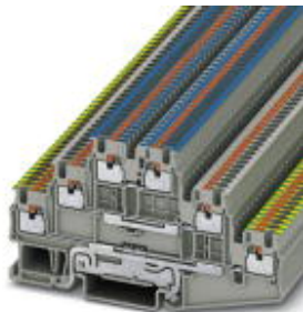
Schutzleiter-Reihenklemme, Anschlussart: Push-in-Anschluss, Querschnitt: 0,14 mm 2 - 1,5 mm 2 , AWG: 26 - 14, Breite: 3,5 mm, Farbe: grau, Montageart: NS 35/7,5, NS 35/15
