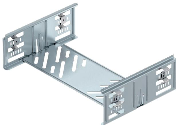
Kabelrinnenverbinder mit Schnellbefestigung für die schraubenlose Verbindung von gelochten Kabelrinnen mit der Seitenhöhe 85 mm.
