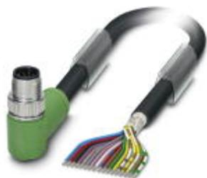
Sensor-/Aktor-Kabel, 17-polig, PUR/PVC, schwarz RAL 9005, geschirmt, Stecker gewinkelt M12 SPEEDCON, A-kodiert, auf freies Leitungsende, Kabellänge: 1,5 m
