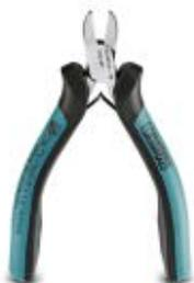
Elektronik-Seitenschneider, runder Kopf, ohne Fase, mit Öffnungsfeder, spiegelpoliert und geölt, 2-Komponenten Griff, Schneidkapazität: weich 0,2 - 2,0 mm; mittelhart 1,2 mm; hart 0,5 mm Durchmesser
