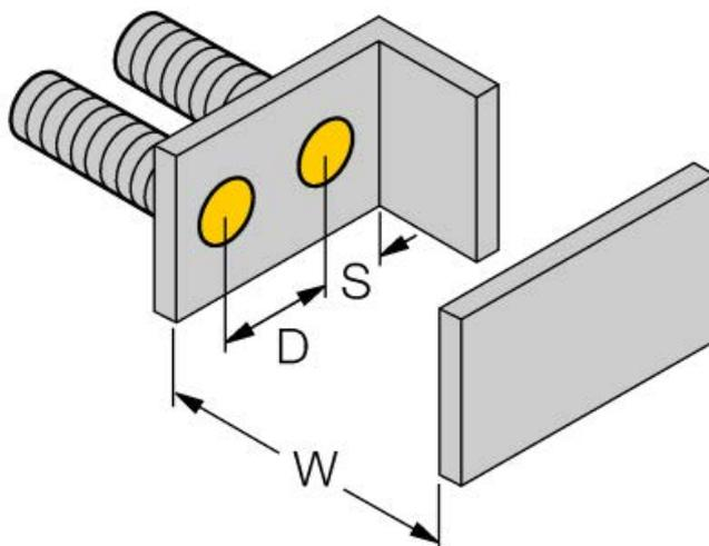
Die angegebenen minimalen Abstände wurden bei Normschaltabstand geprüft.
