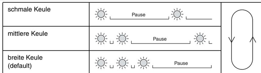
Mit dem Drücken der Taste A1 für 2 Sekunden wird die gewählte Keulenform gespeichert, der Parametriervorgang abgeschlossen und der Sensor kehrt in den Normalmodus zurück. Drücken Sie die Taste A1 statt dessen nur kurz, so gelangen Sie zurück in Stufe 1 (Parametrierung der Ausgangsfunktion).
