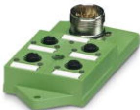
Sensor-/Aktor-Box, Anwendung: Standard, Anschlussart: M12-Buchse Kunststoff, Anzahl der Steckplätze: 4, Polzahl: 5, Steckplatzbelegung: doppelt, Statusanzeige: Ja, pnp; Stammleitungsanschluss: M23-Steckanschluss 90°, Schirmung: nein
