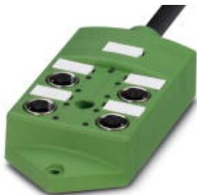
Sensor-/Aktor-Box, Anwendung: Standard, Anschlussart: M12-SPEEDCON-Buchse Metall, Anzahl der Steckplätze: 4, Polzahl: 4, Steckplatzbelegung: einfach, Statusanzeige: Ja, pnp; Stammleitungsanschluss: Festanschluss 180°, PUR/PVC, Leitungslänge: 5 m, Schirmung: nein
