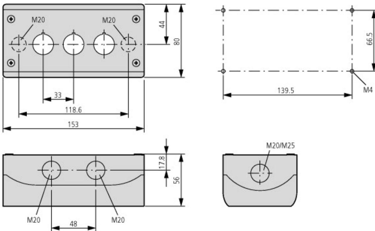
Leitungseinführung vorgepresst: unten: 2 x M20, oben: 2 x M20, seitlich: 2 x M20/M25 (je Seite 1 x)
