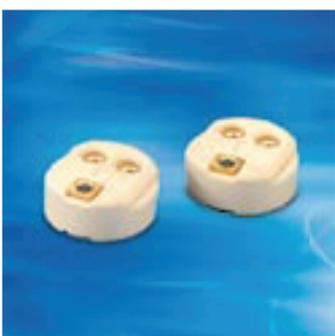
Keramikfassung G5,3/G6,35/ GX6,35/GY6,35, Anschlusselement für Sockel GX5,3 und GZ6,35, Buchsenklemme für Leitungsquerschnitte 0,75-1,5 mm<sup>2</sup>, Schraubbefestigung
