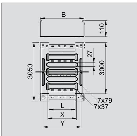
MKSM 110 = Mittelschweres-Kabelrinnen-System-Magic in 110 mm Seitenhöhe. Kabelrinne mit Schnellverbindungs-System, inklusive aller relevanten Verbindungsbauteile zur zeitsparenden und wirtschaftlichen Installation, mit gesickter Längsbohlenlochung 7 x 79 mm zur Auslegermontage. Alle Breiten mit Quersickung zur Stabilisierung und Kabelbelüftung. Durchgängige Seitenlochung 7 x 20 mm als zusätzliche Verbinderlochung.
