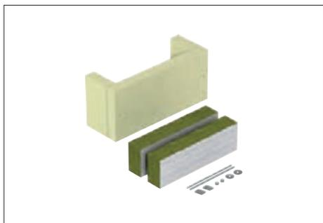
Zugentlastung als wirksame Unterstützungsmaßnahme für senkrechte Kabelverlegung nach DIN 4102 Teil 12, für alle Kabeltypen und alle senkrechten Verlegesysteme zugelassen. Funktionserhaltklassen E30 bis E90. Gehäuse inkl. Mineralfaserplatten, Befestigungsmaterial, Kartusche mit Brandschutzbeschichtung ASX und Kennzeichnungsschild.
