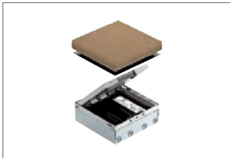
Quadratische Einbaueinheit für den Einsatz in trocken gepflegten Holböden und Estrichböden. Einbaugehäuse mit vorgeprägten Einführungsöffnungen für Rohre (M25). Oberteil durch 4 Nivellierstützen auf Oberkante Bodenbelag einstellbar. Bodenbelagausparung im Klappdeckel 15 mm. Die Mindesteinbautiefe beträgt 95 mm, der Nivellierbereich + 30 mm.
