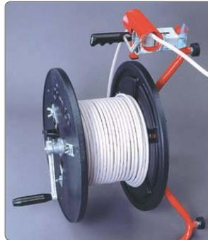
Das Kabellängen-Handmessgerät kann problemlos auf dem Kabelring-Abspuler montiert werden. Einfach den Kunststoffgriff des Kabelring- abspulers abziehen, Messgerät aufschieben und mit Innensechskantschraube fixieren.
