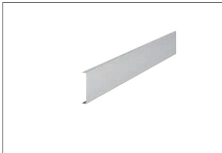
Oberteil aus Aluminium zum Verschließen der Rapid GA Geräteeinbaukanäle und ISS Installationssäulen mit 76,5er Systemöffnung. Der feste Sitz des Oberteils und die elektrische Kontaktierung zum Kanal-/Säulenunterteil ist durch die Rastklammern Typ RKV3V garantiert. In jeder Lieferlänge (2000mm) sind 6 Rastklammern vormontiert.
