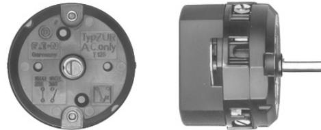
230V~ 16(4)Amp. mit 2pol. Abschaltung. Maße in mm. Tiefe der Achse 40, Achse Ø6, Länge 175 halbrund angeschliffen.
