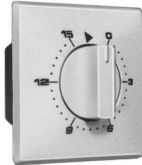
230V~ 16(4)Amp. mit 2pol. Abschaltung, passend in jede UP Schalterdose Ø 68mm. Temp. 125°C. Maße 80x80, Tiefe inkl. Knebel 22 mm.
