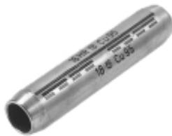
mit Trennsteg für zugentlastete Verbindungen von Mittelspannungskabeln mit Kunststoff- und Papierisolation. Die Pressverbinder werden sechskant verpresst. Durch den Trennsteg wird bei Übergangsverbindungen von kunststoff- auf papierisierte Kabel ein absoluter Ölstopp erreicht.
